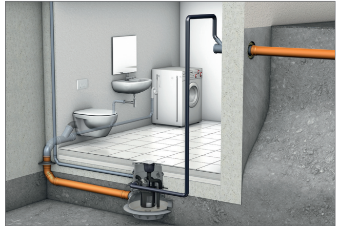
Abb. 40: Funktionsprinzip einer Hebeanlage
